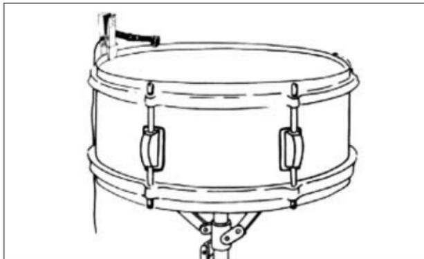
Abb. 5: Befestigung des Mikrofons an der Snare Drum
